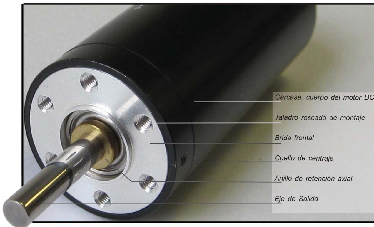
Detalle frontal de un motor DC o micromotor DC (Direct Current) o también llamado motor CC (o motor de corriente continua) que se utilizan generalmente en robótica, automatización, electromedicina, en energía solar para seguidores solares de paneles fotovoltaicos, herramientas de mano, equipos de laboratorio, etc...
