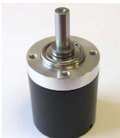
*Reductora planetaria de 2 etapas, para motor pequeño. Acoplada mediante un piñón al eje del micromotor, reduce la velocidad de giro y aumenta el par en proporción a su relación de reducción.*
