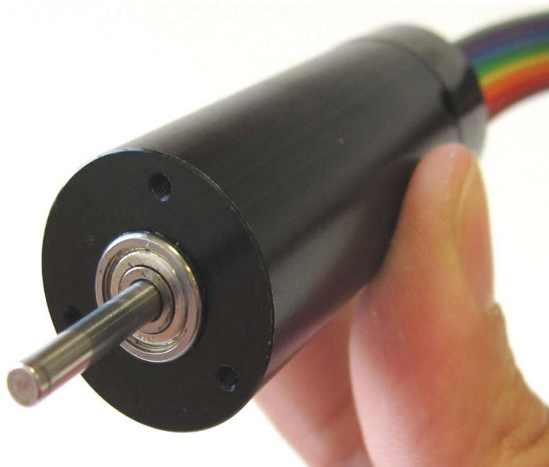
*Micromotor Brushless DC de 22 mm de diámetro. La ausencia de escobillas en la conmutación prolonga la vida útil del motor DC. Sin embargo necesita una electrónica de control de la conmutación*
