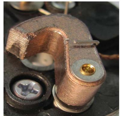
*Escobilla de 50% grafito, y 50% cobre. Se aprecia el inicio del desgaste por su interacción con el colector*
