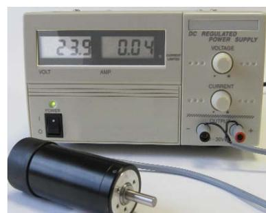
miento más estable Fuente de alimentación dc de laboratorio. El voltaje se puede regular de 0 a 30 V y la corriente de 0 a 3 A
